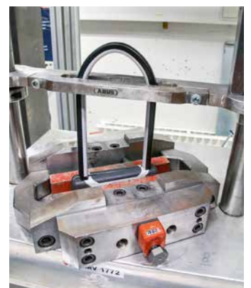
Wie man es dreht und wendet: Verwindungs- prüfung im Testlabor.
