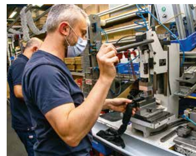
Hochzeit: Hier verbinden sich Schlosskörper und Innenleben.
